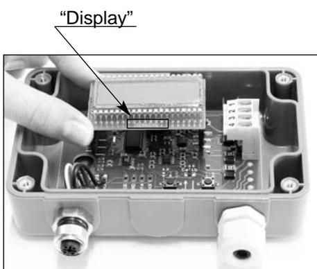
3. **Display lt. Abbildung einsetzen**, auf die Einbaurichtung achten!
